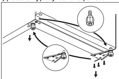
13. Αντιστρέψτε τον κάτω μεντεσέ στην άλλη πλευρά της συσκευής, βιδώστε τον με βίδες και τοποθετήστε τα ρυθμιζόμενα πόδια.
